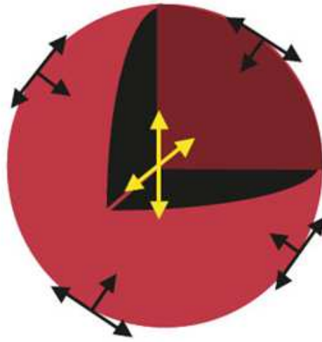
Ilustración 4.1 Gota de sangre esférica con un corte transversal mostrando las fuerzas de tensión superficial.
